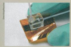
Prototype d'un transistor organique capable de résiter à des environnements naturels corrosifs.
