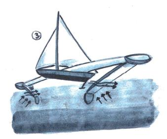
En utilisant ainsi les voiles, la direction du vent réel (a.) forme un angle avec la direction du bateau, et donc celle du vent relatif (b.). Ce dernier s'additionne au vent réel pour former un vent apparent (c.) plus puissant, qui permet au bateau d'aller plus vite grâce à sa propre vitesse. Mais à mesure que le bateau accélère, la résistance à l'avancement, due aux interactions de la coque avec l'eau, augmente jusqu'à ce que le voilier atteigne son allure maximale.
