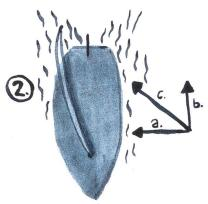
Pour franchir ce palier, la solution consiste à diminuer la résistance à l'avancement. Et comment mieux réduire les interactions avec l'eau qu'en sortant, littéralement, le bateau de l'eau? Cela se fait au moyen de foils, sortes d'ailes subaquatiques au design plus ou moins complexe. Avec la vitesse, ces ailes soulèvent le bateau hors de l'eau, lui permettant d'accélérer encore jusqu'à un nouvel équilibre entre résistance à l'avancement et propulsion.
