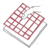
4 Dans le cas de la technologie infrarouge, l'écran est entouré d'émetteurs et de détecteurs à infrarouge. L'utilisation de l'écran interrompt certains des faisceaux au niveau du contact. L'écran a donc ici un rôle passif, et la position du doigt peut être déterminée sans même qu'il y ait besoin de le toucher, un comble pour un écran tactile!
