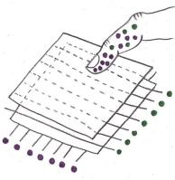
3 Pour la seconde, l'écran transfère des charges électriques à l'utilisateur lorsque ce dernier le touche. Des détecteurs situés aux coins de l'écran localisent l'endroit des pertes. Les matériaux utilisés laissent mieux passer la lumière, mais la technologie ne fonctionne pas si l'utilisateur porte des gants, par exemple, car ceux-ci empêchent le transfert des charges.
