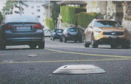
placés sous la roue de l'EPFZ ont ainsi mis au point des systèmes de capteurs qui permettent aux villes de contrôler l'occupation des places de parc pour mieux piloter le trafic. Certaines innovations ont déjà été commercialisées et 17 licences et brevets ont été déposés.
