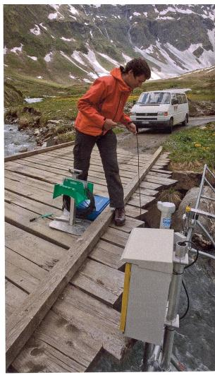
Expérience dans la montagne. Pendant qu'un chercheur prépare la saumure (à gauche), un autre place une sonde dans le torrent.
