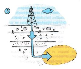
Deux innovations techniques rendent aujourd'hui possible l'extraction des gaz de schiste. Tout d'abord, le forage horizontal qui, après un forage vertical susceptible d'atteindre 5000 mètres de profond, permet de creuser un puits le long du gisement. Ensuite, la fracturation hydraulique, consistant à envoyer sous très haute pression une eau mélangée à 0,5% d'additifs chimiques pour fracturer la roche et créer ainsi la porosité souhaitée.
