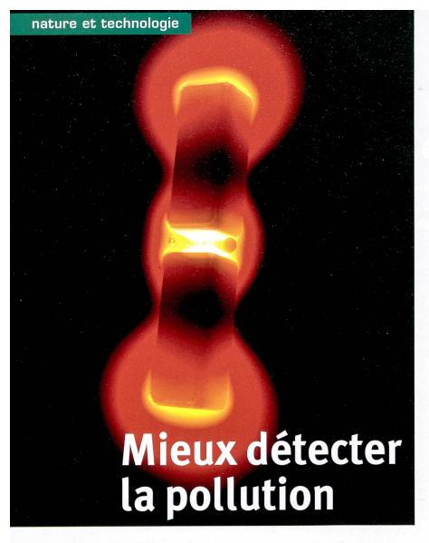
Capables d'amplifier la lumière, de minuscules antennes métalliques permettent d'étudier les propriétés optiques de molécules individuelles.
