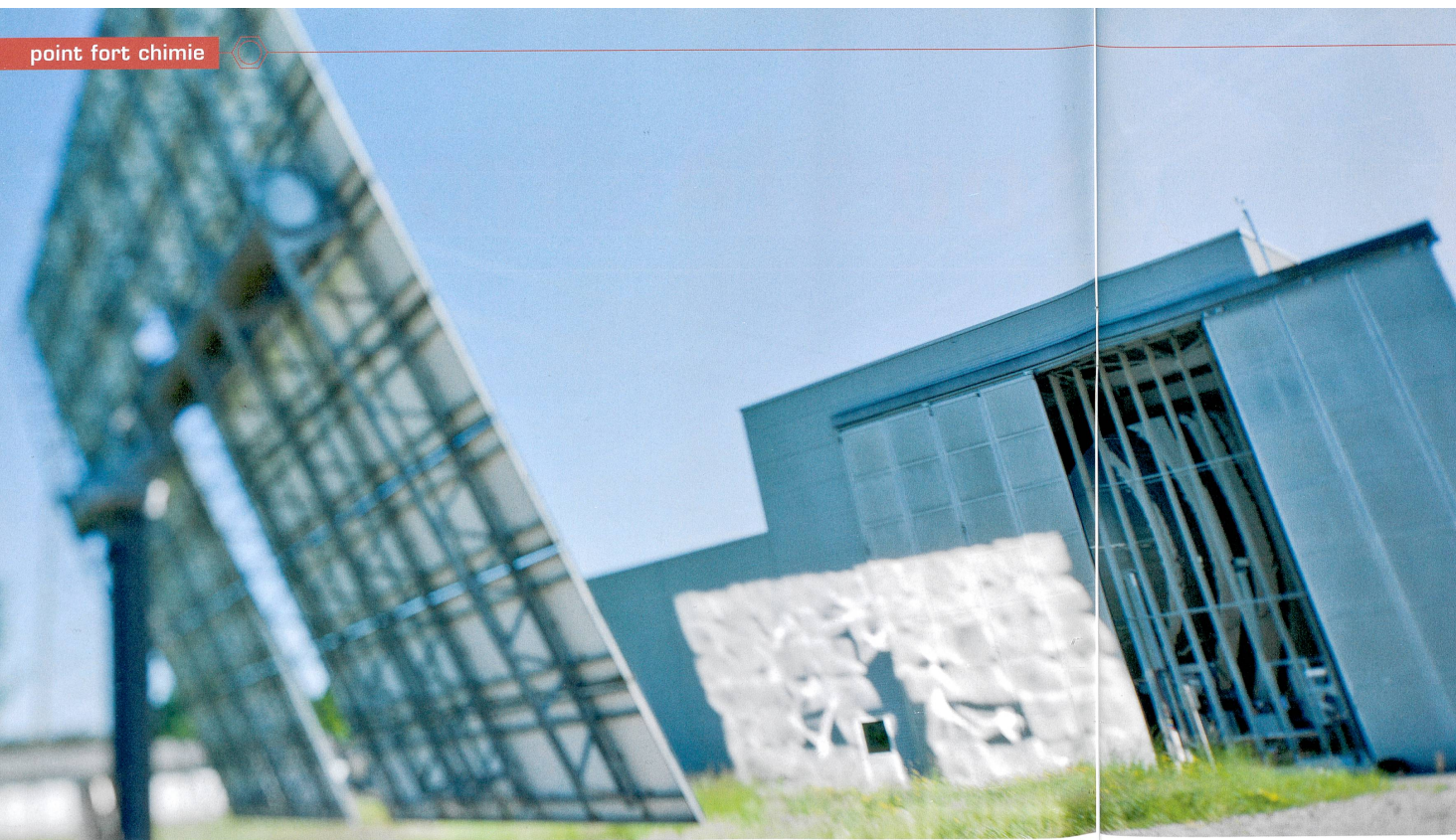
Les miroirs de notre avenir. Le four solaire de l'Institut Paul Scherrer (PSI) est capable de concentrer jusqu'à 5000 fois le rayonnement solaire. Cela permet de tester des réacteurs solaires à haute température. Photo: Derek Li Wan Po
