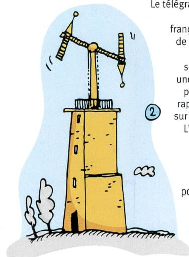
Le télégraphe prend son essor durant la Révolution française, grâce au travail de Claude Chappe. Basé sur le principe du sémaphore de marine, une succession de tours permet de transmettre rapidement des signaux sur une grande distance. L'opérateur d'une tour répète le signal observé sur la tour précédente. Un code associe chaque position du sémaphore à un mot, une phrase ou une expression. Seules les extrémités de la ligne en détiennent la clé.
