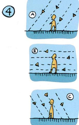
L'aiguille aimantée de la boussole s'aligne sur les lignes de champ. Comme elles ne sont pas parallèles au sol qu'à l'équateur, une extrémité de l'aiguille penche plus ou moins vers le sol. Il faut donc lester l'autre afin que l'aiguille ne touche pas le cadran. Une boussole conçue pour l'hémisphère N ne fonctionne donc pas dans l'hémisphère S car le lest se trouve du mauvais côté.
