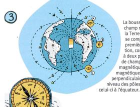
La boussole exploite le champ magnétique de la Terre. Cette dernière se comporte, en première approximation, comme un aimant à deux pôles. Des lignes de champ vont du pôle magnétique N au pôle magnétique S. Elles sont perpendiculaires au sol au niveau des pôles et parallèles à
