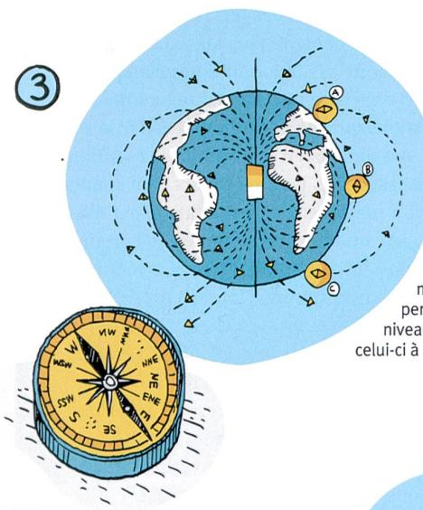
La boussole exploite le champ magnétique de la Terre. Cette dernière se comporte, en première approximation, comme un aimant à deux pôles. Des lignes de champ vont du pôle magnétique N au pôle magnétique S. Elles sont perpendiculaires au sol au niveau des pôles et parallèles à celui-ci à l'équateur.
