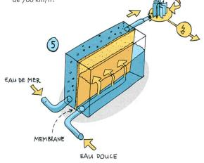
A l'heure actuelle se développe une nouvelle technique de production hydroélectrique, basée sur le phénomène de l'osmose. En filtrant par osmose au travers d'une membrane semi-perméable, de l'eau douce provenant d'une rivière exerce une pression sur de l'eau de mer et l'éjecte vers une turbine. Cette technique, encore expérimentale, est très complexe, mais présente l'avantage d'un faible impact environnemental.
