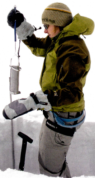
La chercheuse Ruzica Dacic mesure la densité de la neige à différentes profondeurs. En bas: vues du glacier d'Arolla de juin à septembre 2006.
