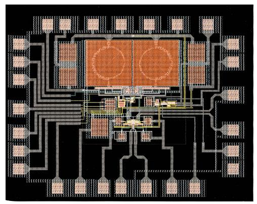
Ce n'est pas un motif de broderie, mais le dessin du circuit intégré d'un récepteur ultra large bande pour des réseaux de senseurs.
