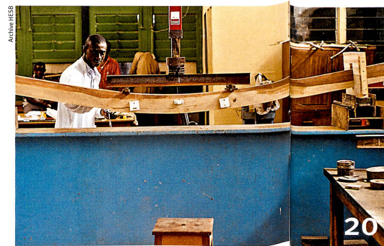
La poutre va-t-elle résister? Au Ghana, on teste des bois tropicaux pour construire des ponts.
