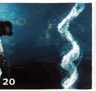
Sous l'effet de la pression, des bulles de vapeur potentiellement destructrices peuvent se produire dans l'eau.
