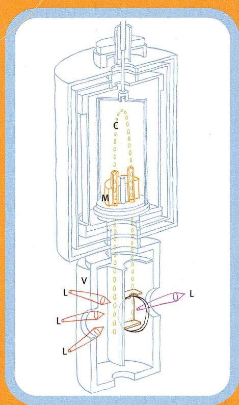
**ILL. 1** Du césium 133 à l'état gazeux est refroidi par laser dans une chambre sous vide, puis concentré en jet atomique continu. Les atomes de césium se retrouvent dans l'un des deux états énergétiques les plus bas. Lorsqu'un atome passe d'un état à l'autre, il吸orbe ou émet de l'énergie sous forme de rayonnement électromagnétique dans le domaine des micro-ondes (9 192 631 770 oscillations par seconde).
