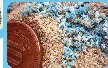
La plage de dunes de Chañaral (grande photo) a l'air magnifique. Elle est toutefois constituée de déchets provenant d'une mine de cuivre (à gauche). Le chlorure de cuivre colore le sable en vert en de nombreux endroits (ci-dessous).
