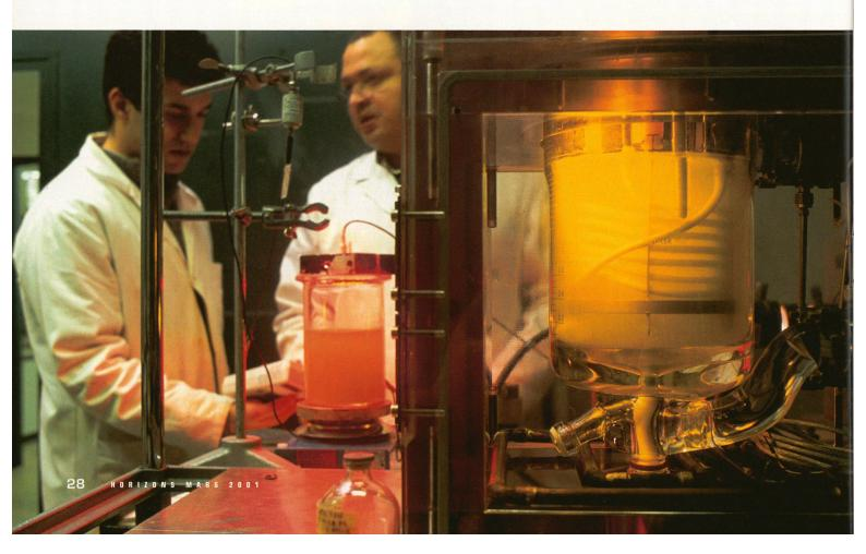
mesure de température pour la biotechnologie est son emploi simple. Elle n'exige aucun prélèvement d'échantillon et peut être réalisée en continu», explique le biotechnologe Ian Marison.
