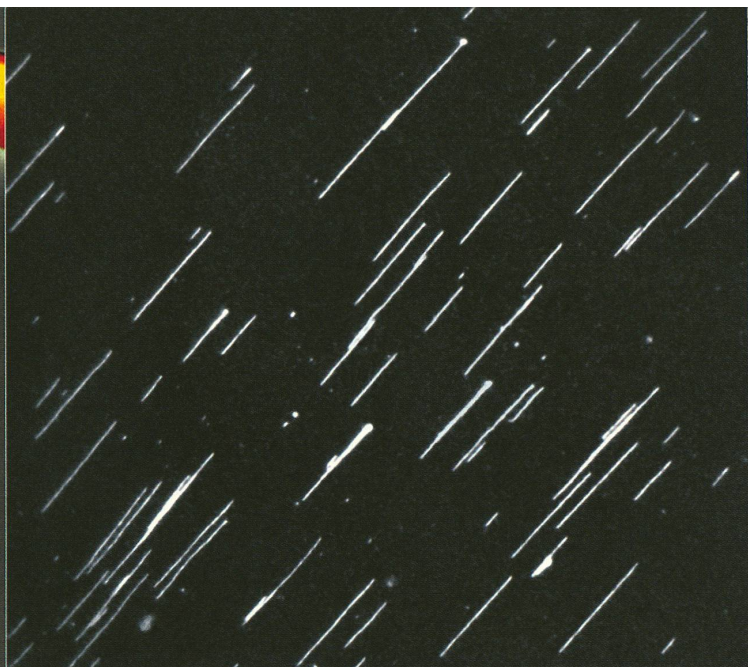
Vues au microscope optique, des molécule d'ADN posées sur un support en silicium. La longueur moyenne de ces molécules est de 20 micromètres.
