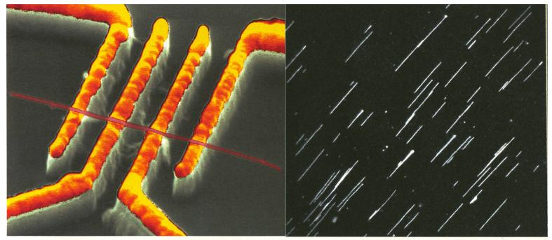
Un nanotube (en rose) posé sur quatre électrodes en or. L'écart entre les électrodes est de 300 nanomètres.
