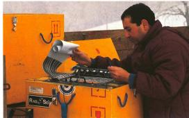
Dans la région lucernoise, les chercheurs bernois procèdent à des sondages (en haut) et recherchent avec un géoradar les couches recelant des objets.
