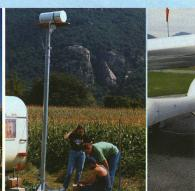
Travail étroit entre mesures sur le terrain et modélisation: à la station de l'EPF, à Claro, dans le Tessin, on utilise (de g. à d.) un anémomètre à ultrasons et un hygromètre à krypton, une sonde radio, une tour météorologique, une sonde atmosphérique et un appareil à mesurer les turbulences installé sur un avion.
