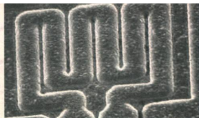
Méandre en diamant servant à mesurer la température dans un capteur de gaz. (Photo CSEM)
