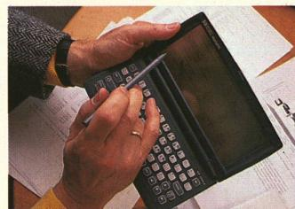
déterminés, qu'il faut se mettre à l'œuvre. Les questions concernées peuvent être cochées avec un stylo sur le touch-screen. Pour les chercheurs, cela signifie qu'il n'y a plus de montagnes de papier ni de risques d'erreurs dans la transcription des données dans l'ordinateur. Les réponses peuvent ainsi être représentées très vite sous forme de graphiques.
