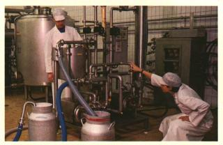
Les spores des bactéries indésirables ne passent plus, grâce au microfiltre en céramique. Mais les bonnes bactéries sont également retenues.
