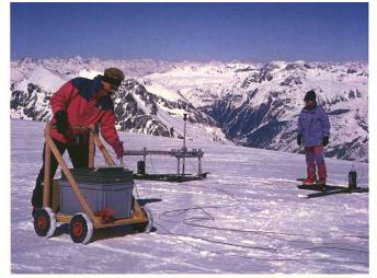
Essais sur la glace: les chercheurs de l'EPF de Zurich étudient les couches géologiques proches du sol à l'aide d'un géoradar mobile.
