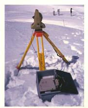
Le théodolite à laser mesure la position du géoradar.
