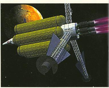
La fusée pour aller sur Mars: les trois moteurs sont alimentés en énergie par des réacteurs nucléaires (au bout des piliers articulés). L'hydrogène est contenu dans les réservoirs jaunes.
