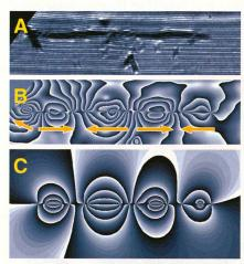
A. Image holographique réalisée à l'aide d'un microscope électronique à transmission. Au centre, on voit un nanofil (longueur: 6 millièmes de millimètre). Les franges qui l'entourent résultent d'interférences produites par deux faisceaux d'électrons.
