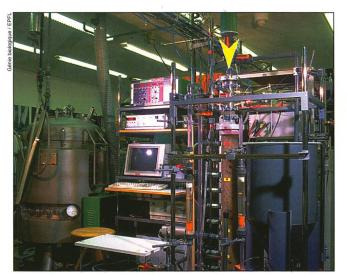
Installation-pilote d'épuration par biofiltre. A gauche, la cuve contenant les eaux usées; le biofiltre est indiqué par la flèche.
