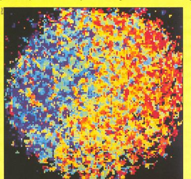
Le Soleil, vu par «hole burning»: en une seule prise de vue, 10 000 images différentes sont saisies simultanément. Ici, les couleurs n'indiquent pas des différences de température, mais trahissent la rotation de l'astre (par effet Doppler). La partie rouge recule par rapport à l'observateur sur Terre, la partie bleue avance.
