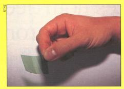
Le film: une matrice de polyvinylbutyral, dans laquelle sont réparties des molécules de chlorine (2,3-dihydroporphyrine) qui lui donnent sa couleur verte.
