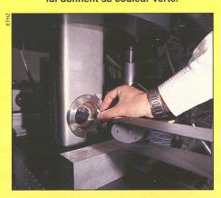
Le film est placé au coeur de ce cylindre. Grâce à un circuit d'hélium liquide, il est refroidi à une température de -271°C. La lumière du Soleil, collectée par un télescope, est dirigée sur le film à travers le hublot.
