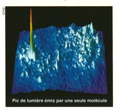
goutte d'hexadécane (un hydrocarbure), à une température seulement deux degrés plus élevée que le froid le plus absolu (-271°C). Figé par le froid, l'hexadécane est transparent et ressemble à un grain de sel. Dans l'hexadecane, les chercheurs ont placé quelques molécules de terry-lène, qui sont prises dans la masse comme des raisins dans un cake. Ils braquent ensuite sur le grain gelé un laser rouge, dont la qualité de lumière est variéè en continu...
