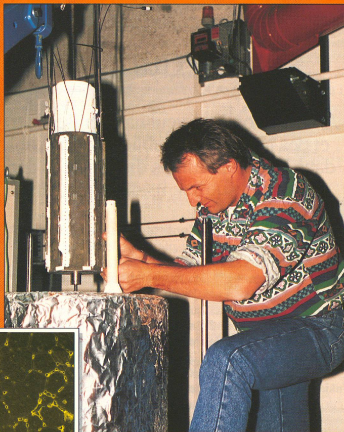
En haut: Montage d'un prototype de pile à combustible de 1000 watts, composé d'un empilement de 50 disques.
