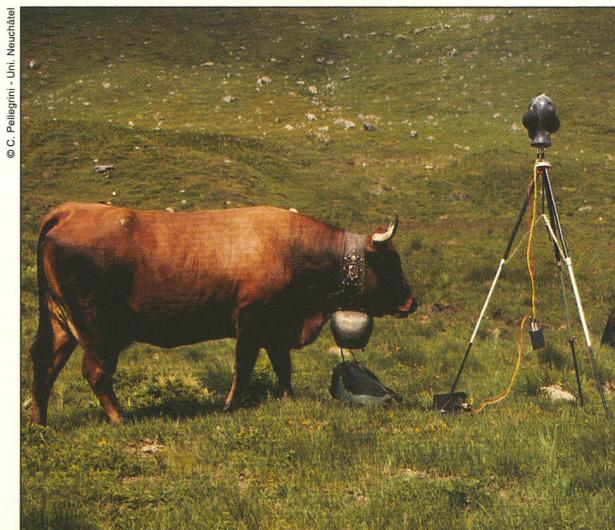
Piège à sons haute fidélité: la tête artificielle au sommet du trépied contient un micro dans chaque oreille.
