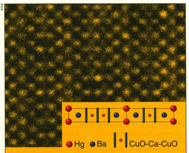
Vu au microscope électronique à transmission, le matériau supraconducteur développé par l'équipe du Prof. Ott. A ce très fort grossissement, on distingue les atomes de l'arrangement cristallin. Les chercheurs n'ont pas encore bien compris les mécanismes qui permettent à la supraconductivité de s'installer dès -140°C. L'élaboration d'une bonne théorie à l'échelle microscopique fait ainsi partie des priorités de la recherche.
