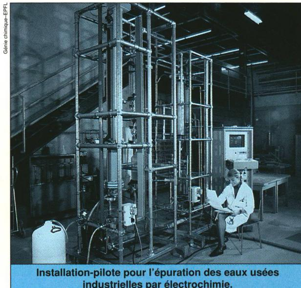
Installation-pilote pour l'épuration des eaux usées industrielles par électrochimie.
