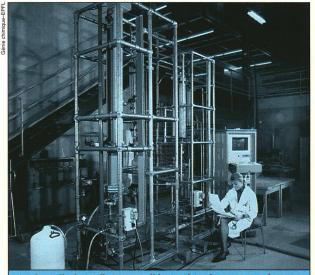
Installation-pilote pour l'épuration des eaux usées industrielles par électrochimie.
