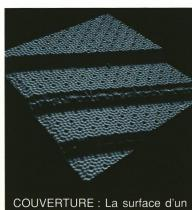
COUVERTURE: La surface d'un cristal de silicium vue au *microscope à effet tunnel*. Sur cette image spectaculaire, on distingue les atomes individuels, ainsi que quatre "marches d'escalier" hautes de quatre atomes.
