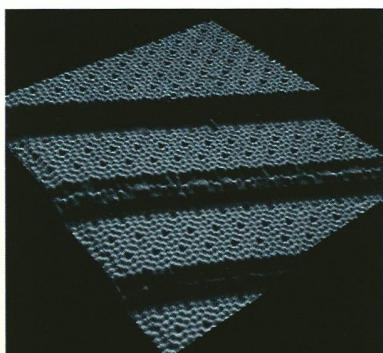
**COUVERTURE :** La surface d'un cristal de silicium vue au *microscope à effet tunnel*. Sur cette image spectaculaire, on distingue les atomes individuels, ainsi que quatre "marches d'escalier" hautes de quatre atomes.
