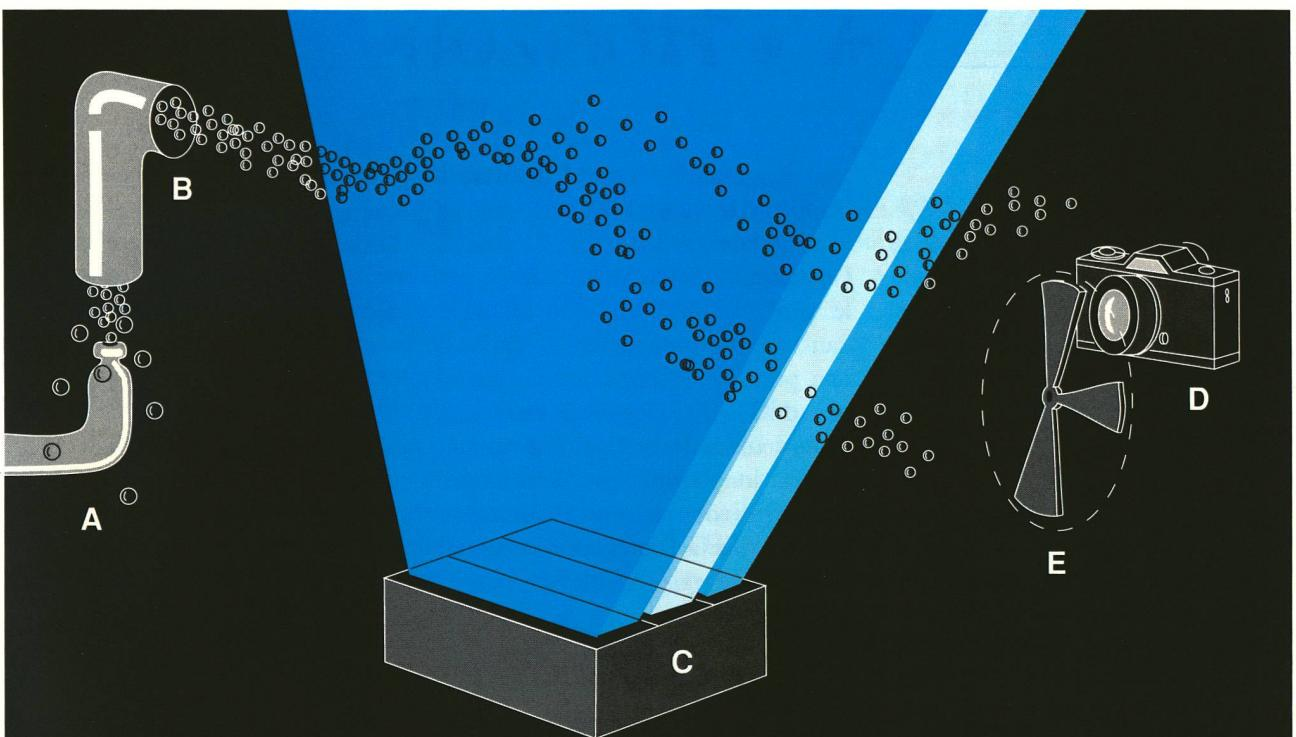
**VOIR LES COURANTS D'AIR** Dans l'obscurité, des petites bulles de savon (environ 4 millimètres de diamètre) sont produites par une buse (A). Un conduit coudé (B) sélectionne les plus légères d'entre elles pour les acheminer vers le lieu de l'expérience, éclairé par un dispositif lumineux produisant trois "parois de lumière" de couleur différente (C). En changeant de paroi, les bulles vont se colorer différemment, ce qui indiquera leur position dans le sens de la profondeur.
