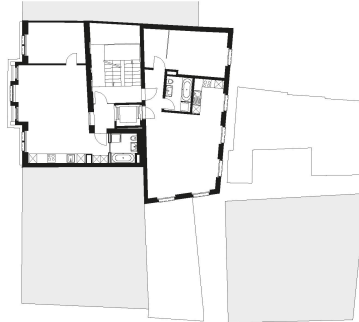
^ Das neue Treppenhaus verbindet das hohe Vorderhaus mit dem neuen Hinterhaus.
