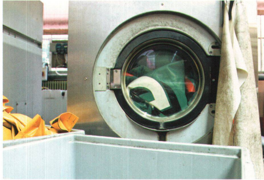
∨ Produktion bei Freitag Taschen: Gebrauchte LKW-Planen werden gewaschen und auf ihre Verwertung vorbereitet.
