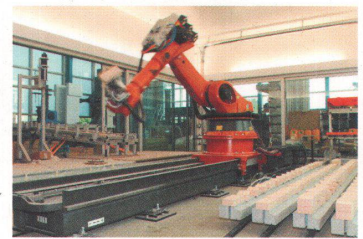
Maurerroboter an der «Swissbau»
