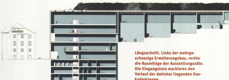
Längsschnitt. Links der mehrgeschossige Erweiterungsbau, rechts die Raumfolge der Ausstellungssäle. Die Eingangstore markieren den Verlauf der dahinter liegenden Kaskadentreppe
