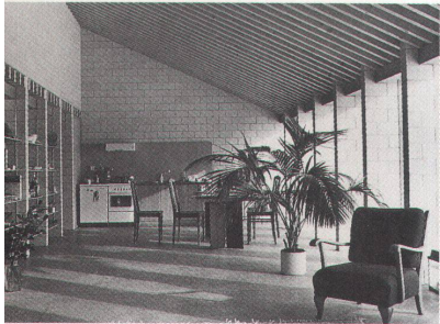
Der Wohnraum im Obergeschoss mit der Küche an der Stirnseite. Auf den Trägern liegt eine Lage Kalksandsteine als Speicher
