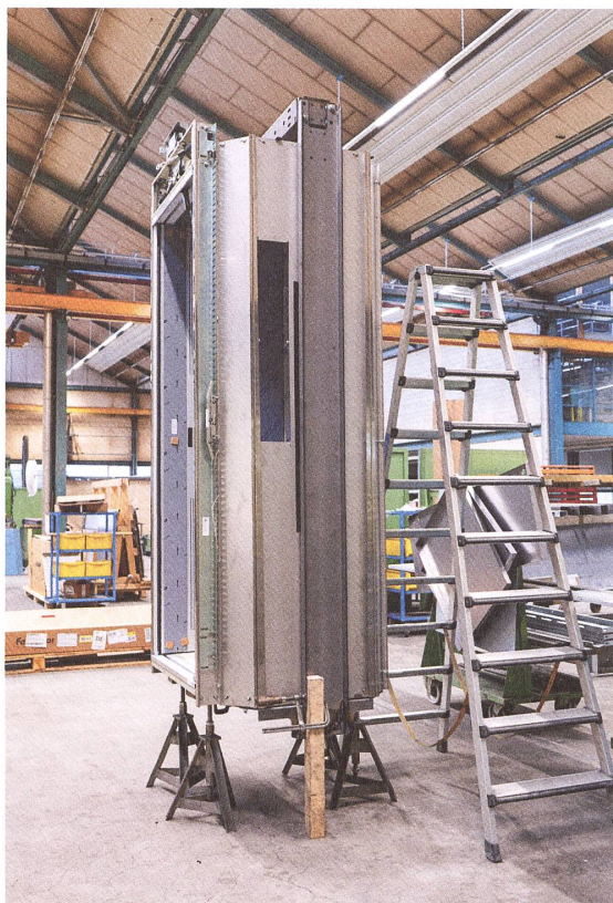
Wohnhaus mit Kleinwohnungen, 1960/61 Clausiusstrasse, Zürich Architektur: Ernst Gisel, Zürich Technische Angaben: – seilmechanischer Personenaufzug mit Maschinenraum über dem Liftschacht – Nutzlast 180 kg / 2 Personen – 5 Haltestellen – 11,83 m Förderhöhe
