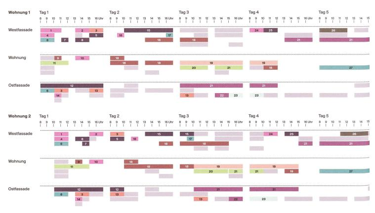
Jeweils vier Wohnungen wurden gleichzeitig saniert, die Bauarbeiten dauerten zehn Tage. Der obige Ausschnitt aus dem Sanierungsplan zeigt den Bauprozess für zwei Wohnungen.
