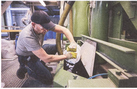
Polymer- und Zellulosefasern kommen in Form von Bäschen ins Materialgemisch.
