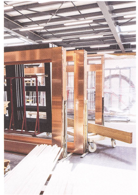
Holz-Kupfer-Fenster in der Werkhalle. Foto: Jonas Weibel
