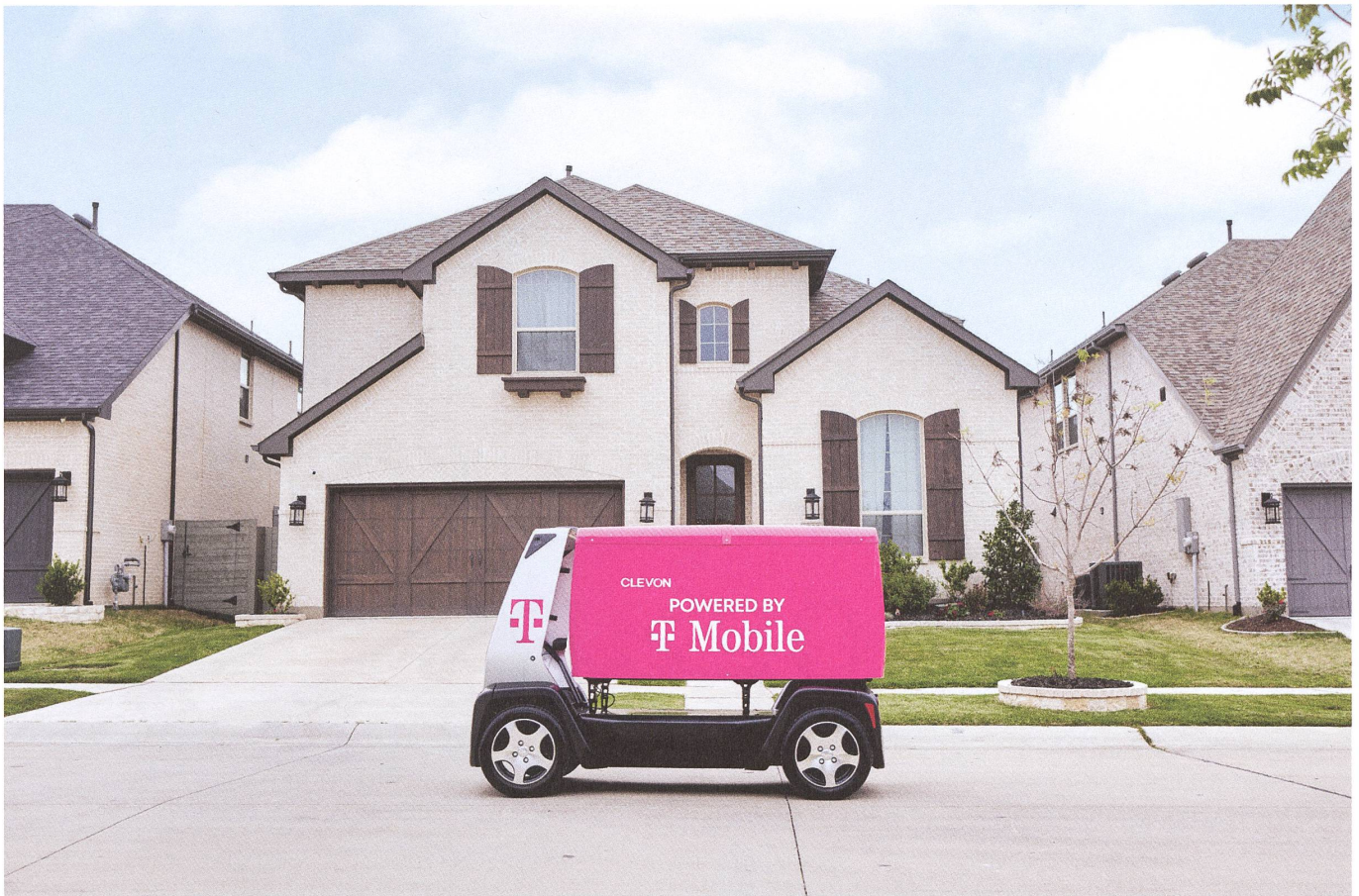
«Clevon» aus Estland ist eine Plattform für unterschiedliche Cargo-Module. Das fixe Frontsegment verbindet Plattform und Modul formal und integriert die Sensorik.
