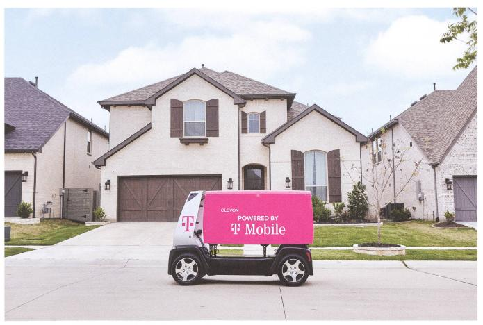
«Clevon¹» aus Estland ist eine Plattform für unterschiedliche Cargo-Module. Das fixe Frontsegment verbindet Plattform und Modul formal und integriert die Sensorik.
