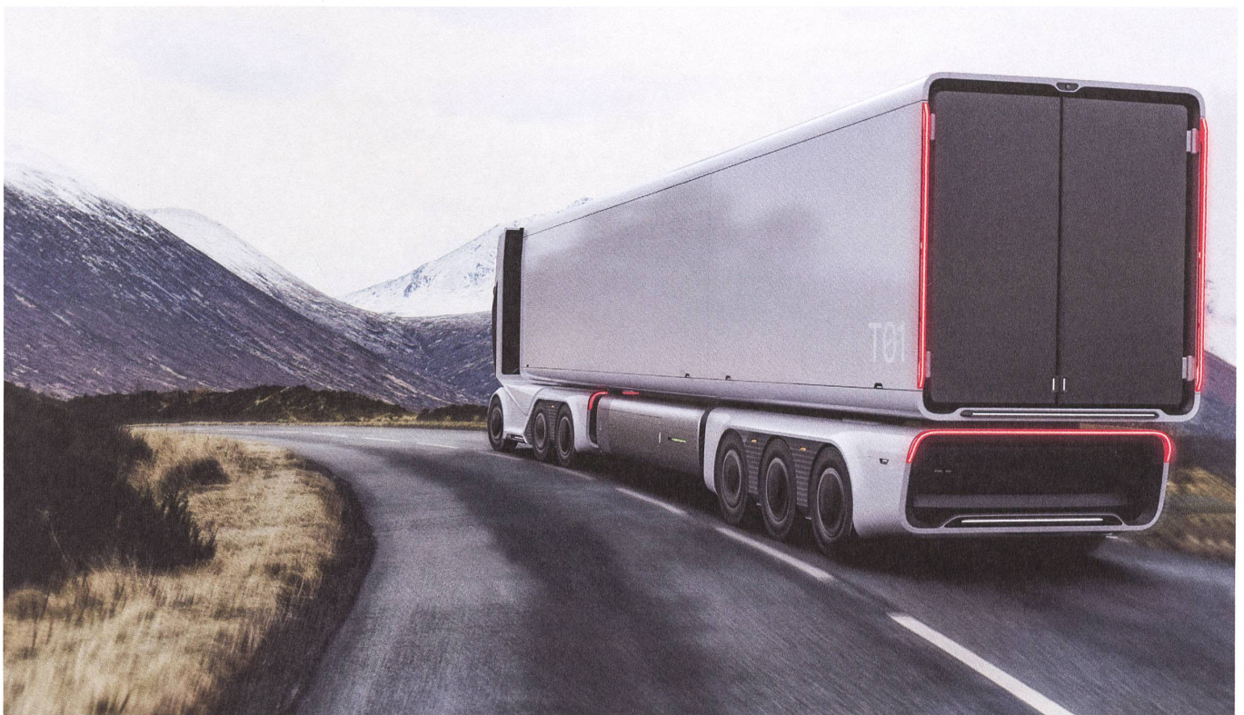
Einride zeigt sich designaffin wie auch technisch innovativ: Zusätzliche Batterien im Auflieger des LKW vergössern die Reichweite der elektrischen Zugmaschine.
