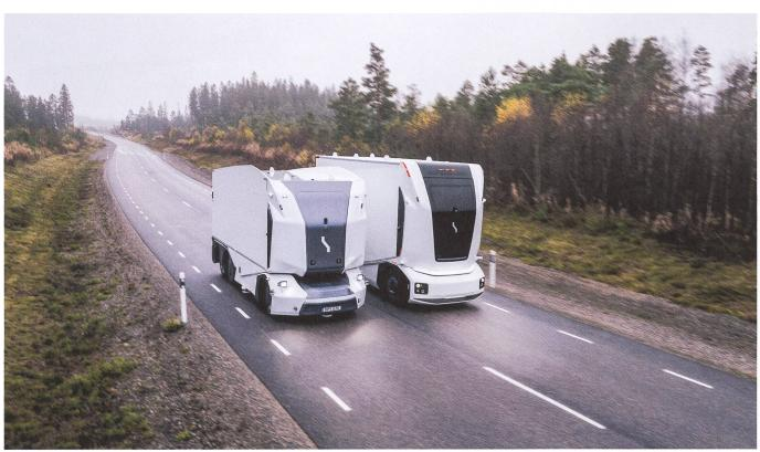
Vollelektrisch: Die beiden Varianten des «Autonomous Gen» von Einride verbinden Logistik-Hubs untereinander. Weil die Fahrerkabine fehlt, lässt sich mehr Fracht laden.
