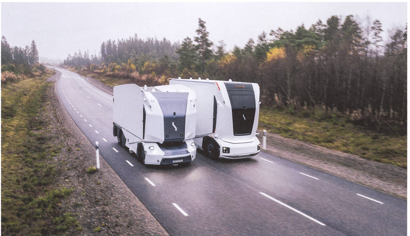
Vollelektrisch: Die beiden Varianten des «Autonomous Gen» von Einride verbinden Logistik-Hubs untereinander. Weil die Fahrerkabine fehlt, lässt sich mehr Fracht laden.
