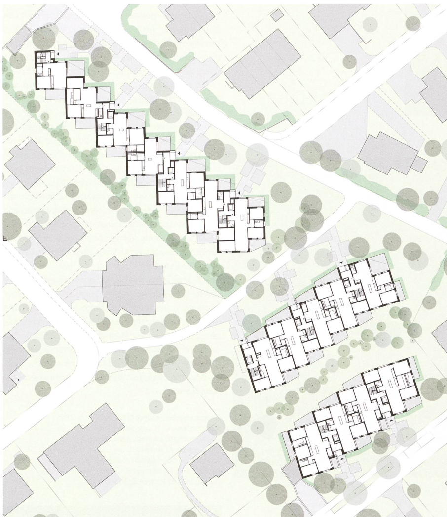
Erdgeschosse der drei Hauszeilen
