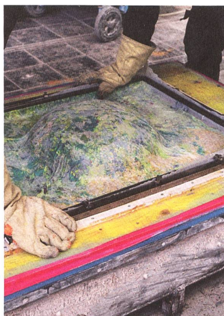
Nach dem Schmelzprozess entsteht eine terrazzoartige Oberfläche.
