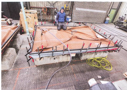
Eine Vakuumpumpe entzieht dem Lehm die Feuchtigkeit.
